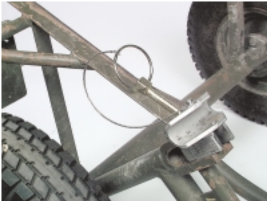
Bild 4:1 a Lagersatserna monteras i utläggningsskärta 3
