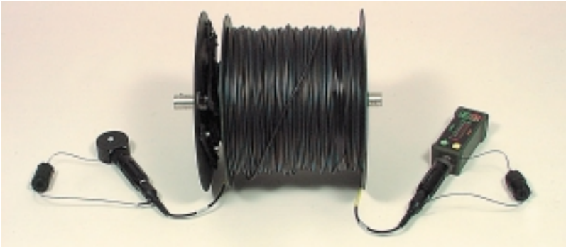
Bild 4:10 a Mätning med mätton FIKA av ett kabelstycke
