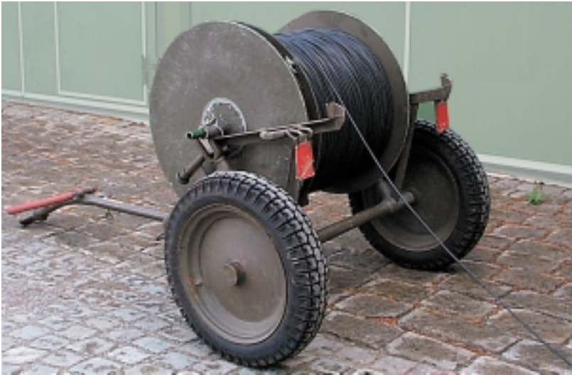
Bild 4:1 c Optokabel 2000 m MR monterad på utläggningsskärna 3
