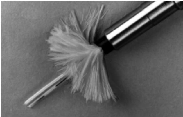
Bild 11:3 Uppbyggnad av en optokabel
